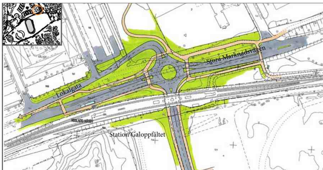
Förslag till ny gata med gång- och cykelbanor under Roslagsbanan vid station Galoppfältet och ny korsning med Stora Marknadsvägen (Källa WSP 130123)
