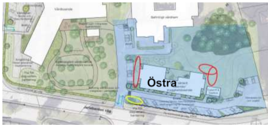
Figur 10 Blåmarkerat område visar omfattningen för systembeskrivning östra delen. Röda markeringar: lämpliga ytor för omhändertagande av dagvatten från takytor. Gul markering: lämpliga ytor för dagvatten från parkeringsyta.
