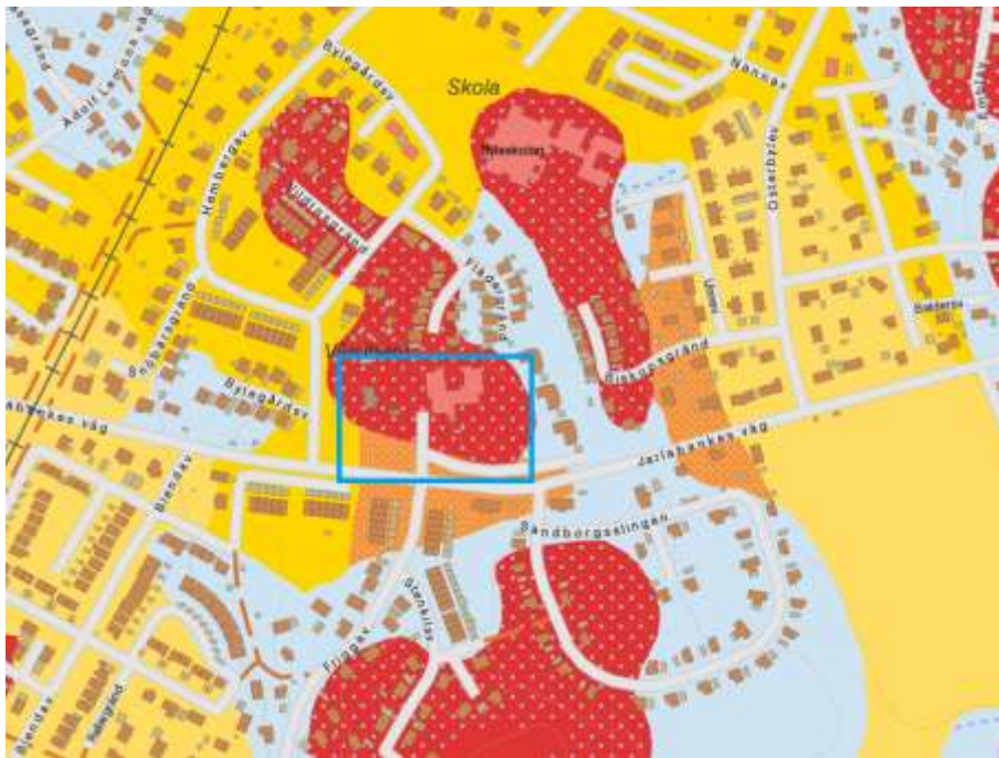
Figur 4. Jordartskarta över planområdet, markerad i blått. Det orangea området närmast Jarlabankesväg är postglacial sand, röda området är urberg, de blåprickarna är morän. Det gula området i väster är glacial lera. (Källa. SGU Jordartskarta, 2017)
