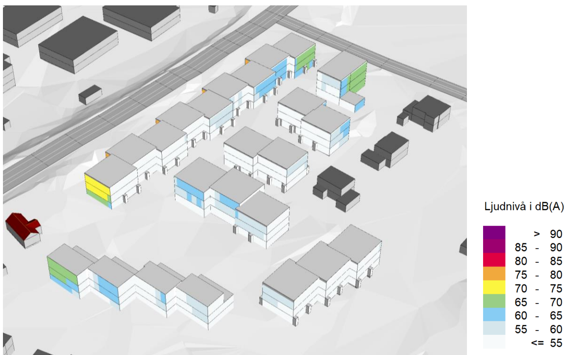
Figur 7. Maximal ljudnivå (frifältsvärde) vid fasad från vägtrafik för prognosår 2040. Vy från nordväst.
