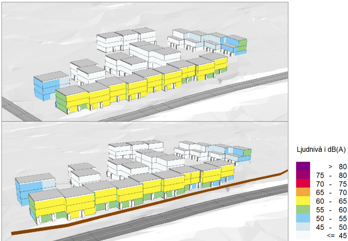
Figur 11. Ekvivalent ljudnivå (frifältsvärde) vid fasad från vägtrafik för prognosår 2040, i den övre figuren utan åtgärdsförslag och i den undre figuren med en 1,4 m hög bullerskyddsskärm (visas i brunt). Vy från öster.
