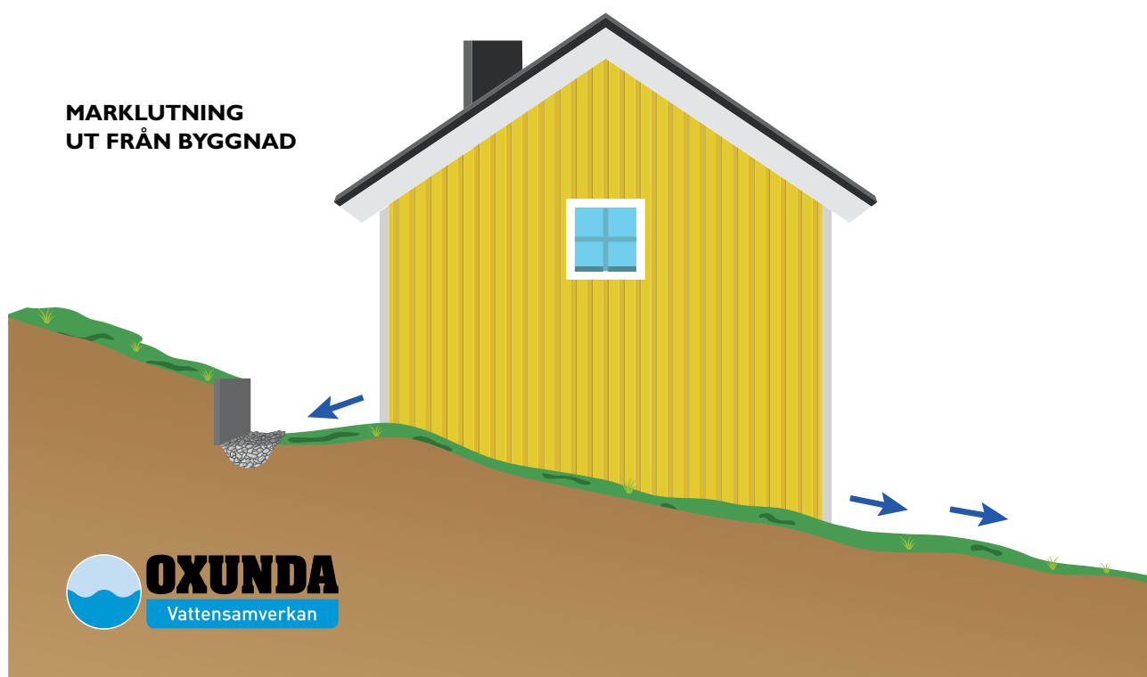
Marken kring huset lutas utåt för att undvika fuktskador.
