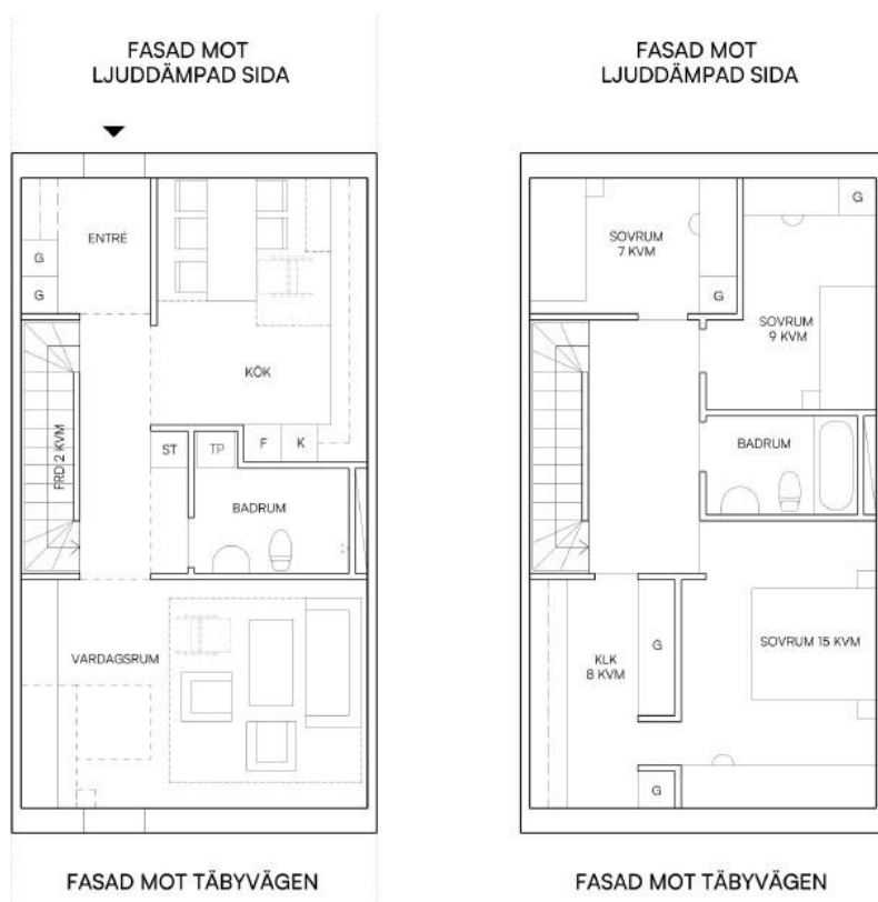
Figur 24. Typplan för lägenhet i radhus intill Täbyvägen, där hälften av bostadsrummen är orienterade mot ljuddämpad sida.
