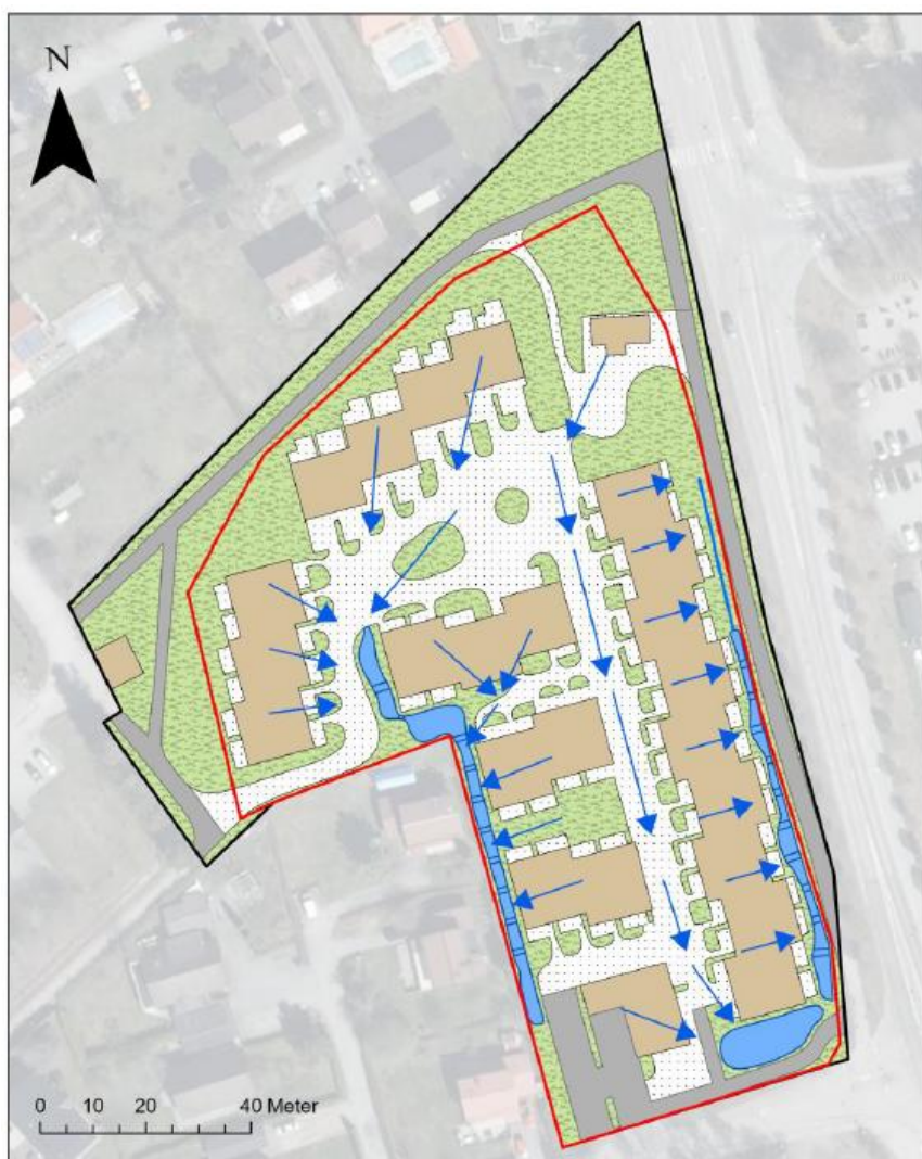
Figur 23. Flödesriktningar för dagvattenhantering inom Bromsen 11.
